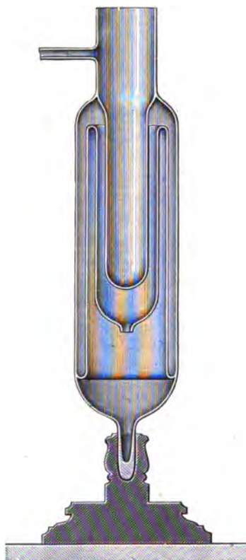
Weinhold'sches Gefäß für flüssige Luft.
